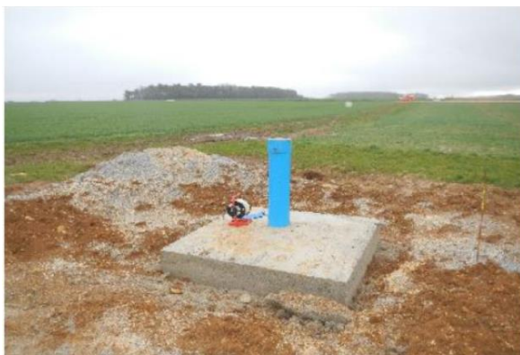
Piézomètres mis en place en amont (à gauche) et en aval (à droite) du site dans le cadre de la future autorisation (ANTEA)
