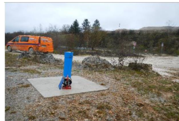
Piézomètres mis en place en amont (à gauche) et en aval (à droite) du site dans le cadre de la future autorisation (ANTEA)
