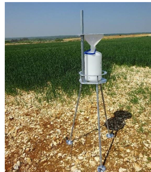
Jauge de mesure de retombées de poussières mise en place à Jully-sur-Sarce (ENCEM)
